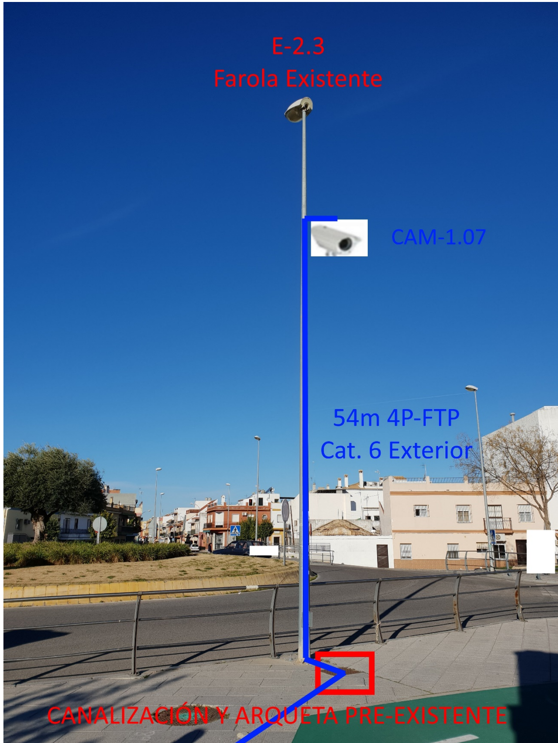
E-2.3: Simulación y Fotomontaje de las Cámaras y equipamiento del emplazamiento exterior.
