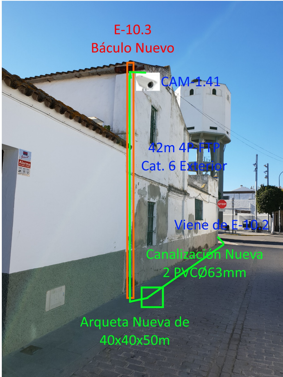
E-10.3: Simulación y Fotomontaje de las Cámaras y equipamiento del emplazamiento exterior.
